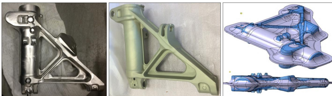
Figure I- 1 : Composante de train d'atterrissage a) après forgeage et usinage grossier, b) après usinage de finition et c) superposition de la pièce après préformage et forgeage de finition.
