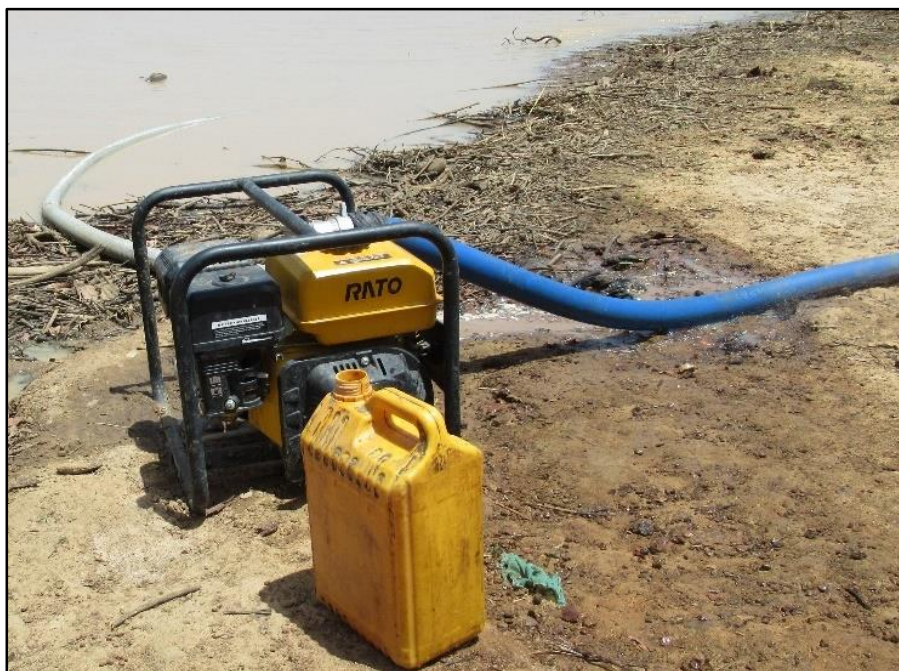
Figure 48. La motopompe et le tuyau pour l'alimentation de l'étang en eau et sa vidange (source : nos clichés, mars 2019)
